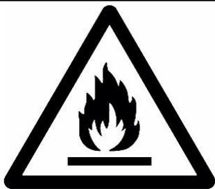
Cet appareil contient un fluide frigorigène inflammable de type R290.
