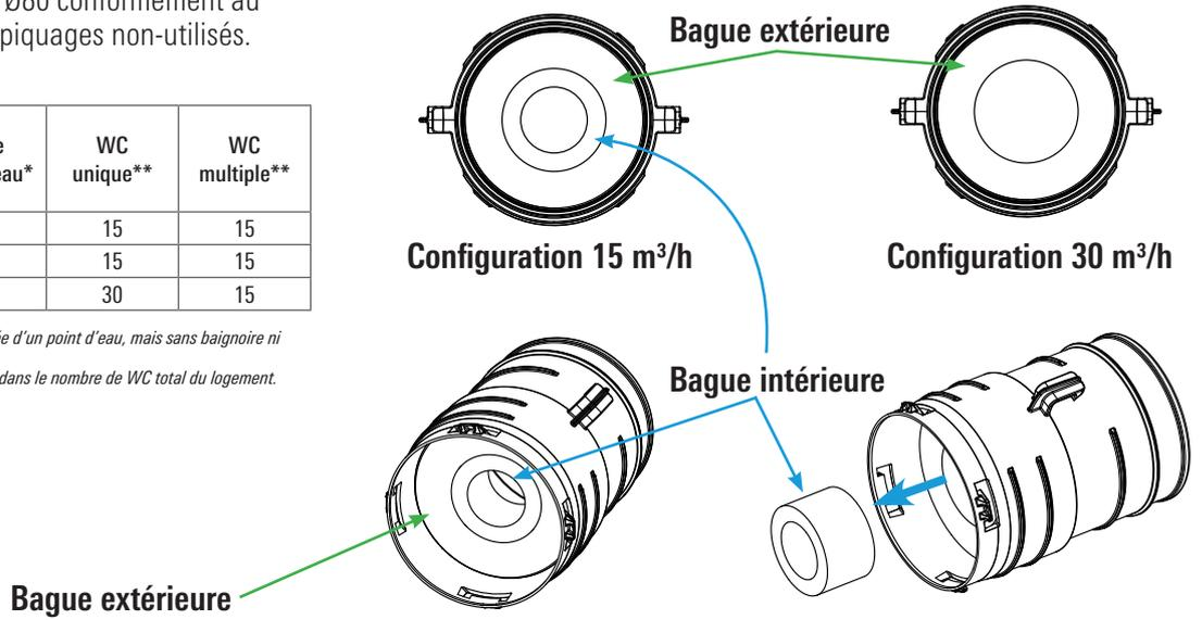
Les piquages sanitaires sont montés d'usine en configuration 15 m³/h. Pour passer en configuration 30 m³/h il suffit de retirer la bague intérieure, tout en conservant la bague extérieure.
